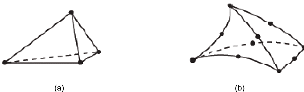
Figura 5.2 - Elementos tetraédricos lineares: (a) 4 nós - C3D4; (b) 10 nós - C3D10
